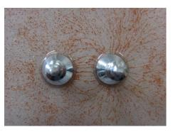
図2. 異符号に帯電させたネジの周りの粉末。
