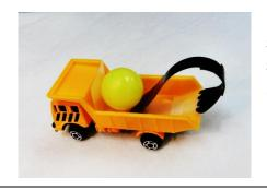
図 1. 視覚的な重力計の例。 板バネの上の玉は、無重力になると打ち 上げられる。
