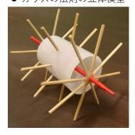
図 2. 直線上に帯電した物体の周り電界 を表した立体模型。 赤色で示した箇所が帯電している。
