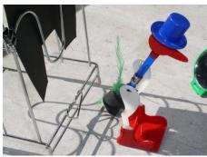
図3. 水飲まない鳥。 水がなく頭部が乾いている状態では動作 しない。しかし日光が胴体部にだけ当たる ように日除けを設置すると、頭部と胴体部 に温度差が生じるため、鳥は動作する。
