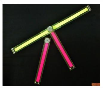
図1. 2種類の剛体振り子。 直線型振り子(左下)と T字型振り子(右上)で、
