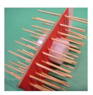
図3. 平面上に帯電した物体の周りの電界を表した立体模型。 赤色で示した箇所が帯電している。
