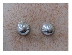
図1. 同符号に帯電させたネジの周りの粉末。
