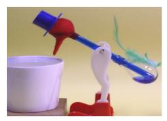
水飲み鳥。 内部の液体の動きを観察し、動作原理を理 解させる。頭部が水で濡れていることが動 作に必要であることがわかる。
