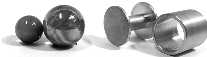
図3 大・小の球、及び同じ直径、同じ重さの「糸巻き」と「パイプ」
