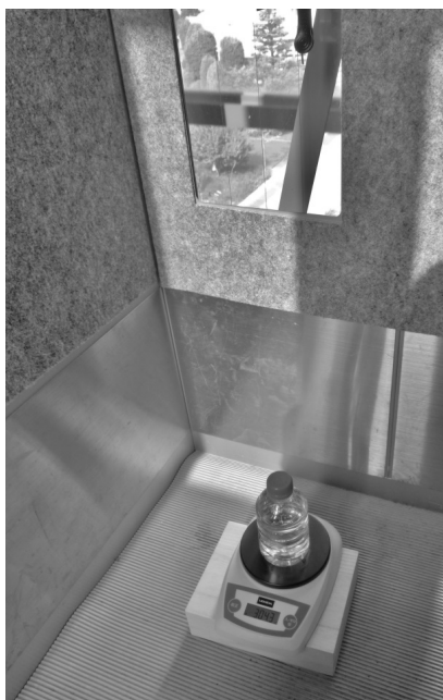
図1 エレベーター内における電子天秤による重量測定
